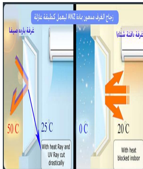
شكل (٣-١) رسم توضيحي يبين كيف يعمل الدهان الشفاف العازل للنوافذ مما يعمل على وفر الطاقة ١٠
